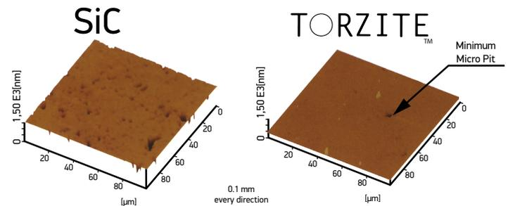
Минимизация микропор материала Torzite, которые изнашивают леску. Зеркальное покрытие Torzite намного лучше, чем SiC.
